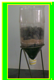
Figura 1: Filtros em garrafas PETs, constituídos de carvão ativado, areia e brita.
