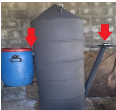
Figura 03- Biodigestor piloto com escape de gás na caixa de saída. Fonte: winderson/ 2011.
