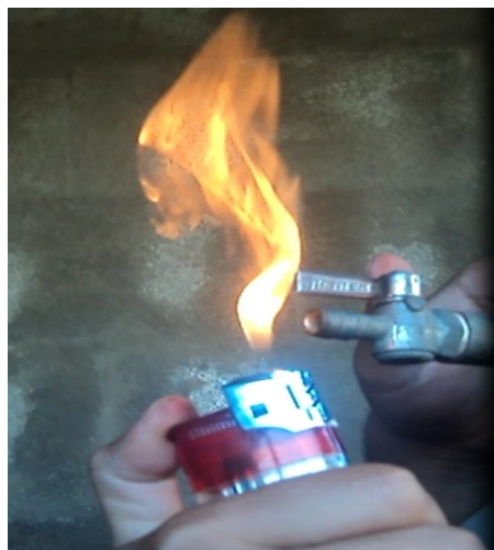
Figura 04- Queima de gás do Biodigestor piloto. Fonte: Lorena/ 2012.
